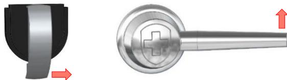
2. Saisissez le code, puis, dans un délai de 3 secondes **après** le double signal sonore, faites tourner la poignée d'ouverture en position ouverte dans le sens des aiguilles d'une montre.
